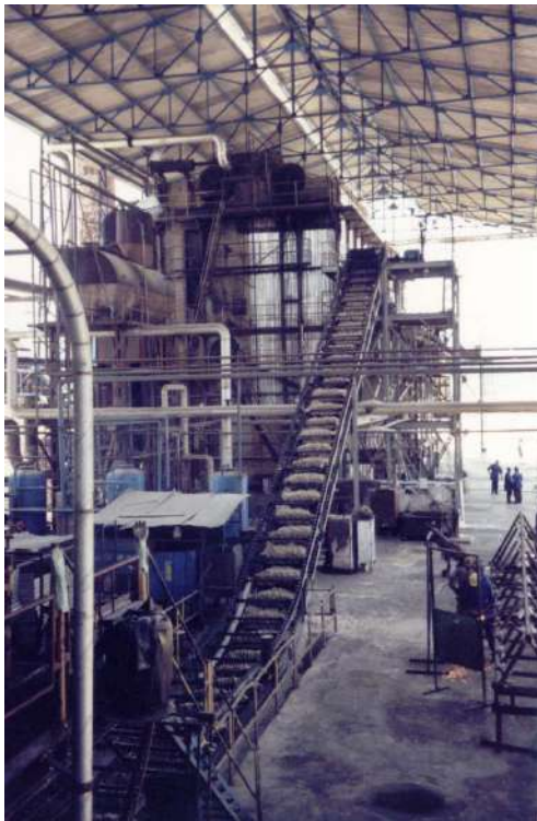
Foto 28: Alimentação de bagaço na caldeira - Destilaria Pindorama (em operação)
