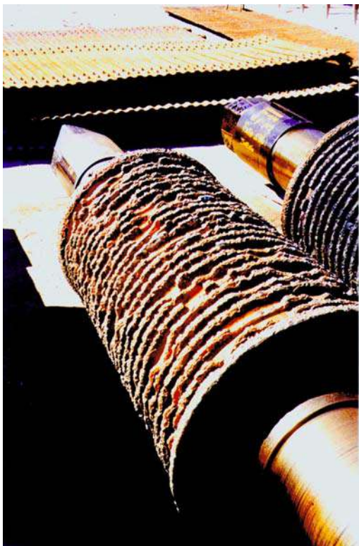
Foto 5: Vista das moendas (em manutenção) Destilaria Pindorama
